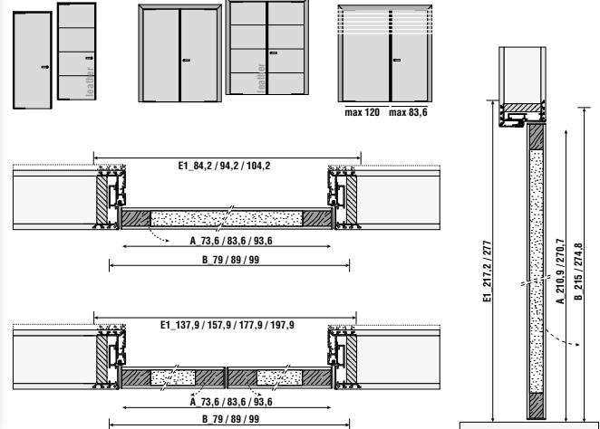
A\_Modulo / Panel - B\_Luce netta falsotelaio / Subframe measurement - E<sup>1</sup>\_Ingombro per riduzione spessore vano esterno / Dimensions for reducing the thickness of the external subframe
