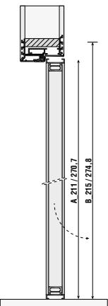
A\_Modulo / Panel - B\_Luce netta falsotelaio / Subframe measurement - E<sup>1</sup>\_Ingombro per riduzione spessore vano esterno / Dimensions for reducing the thickness of the external subframe
